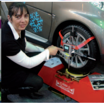
Anja Reichenbach von Koch Achsmessanlagen demonstriert die Fahrwerkprüfung am Auto
